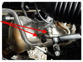
Figure 2 - Remove Stud Nuts
